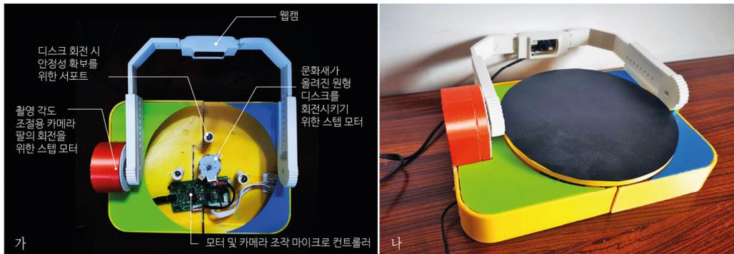
〈그림 3〉. (가) 3D 스캐너 내부 구조 및 부품 (나) 조립이 완료된 3D 스캐너
