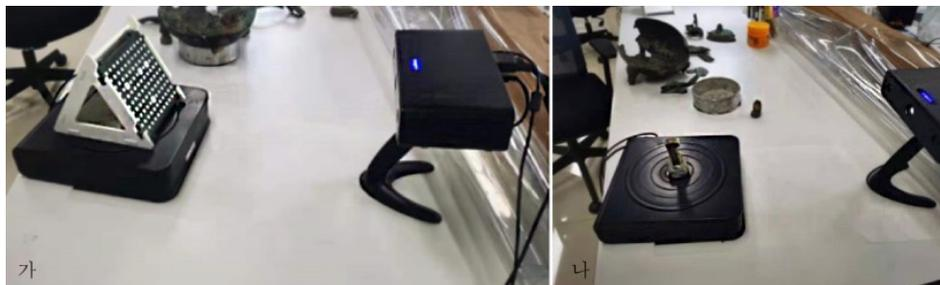
〈그림 6〉 (가) 스캐너 캘리브레이팅. (나) 청동정이 스캐닝 모습
